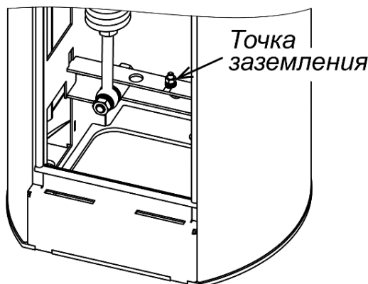
Рисунок 26. Расположение точки заземления шлагбаума
